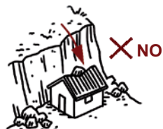
No construir en barrancos ni zonas de derrumbe.
